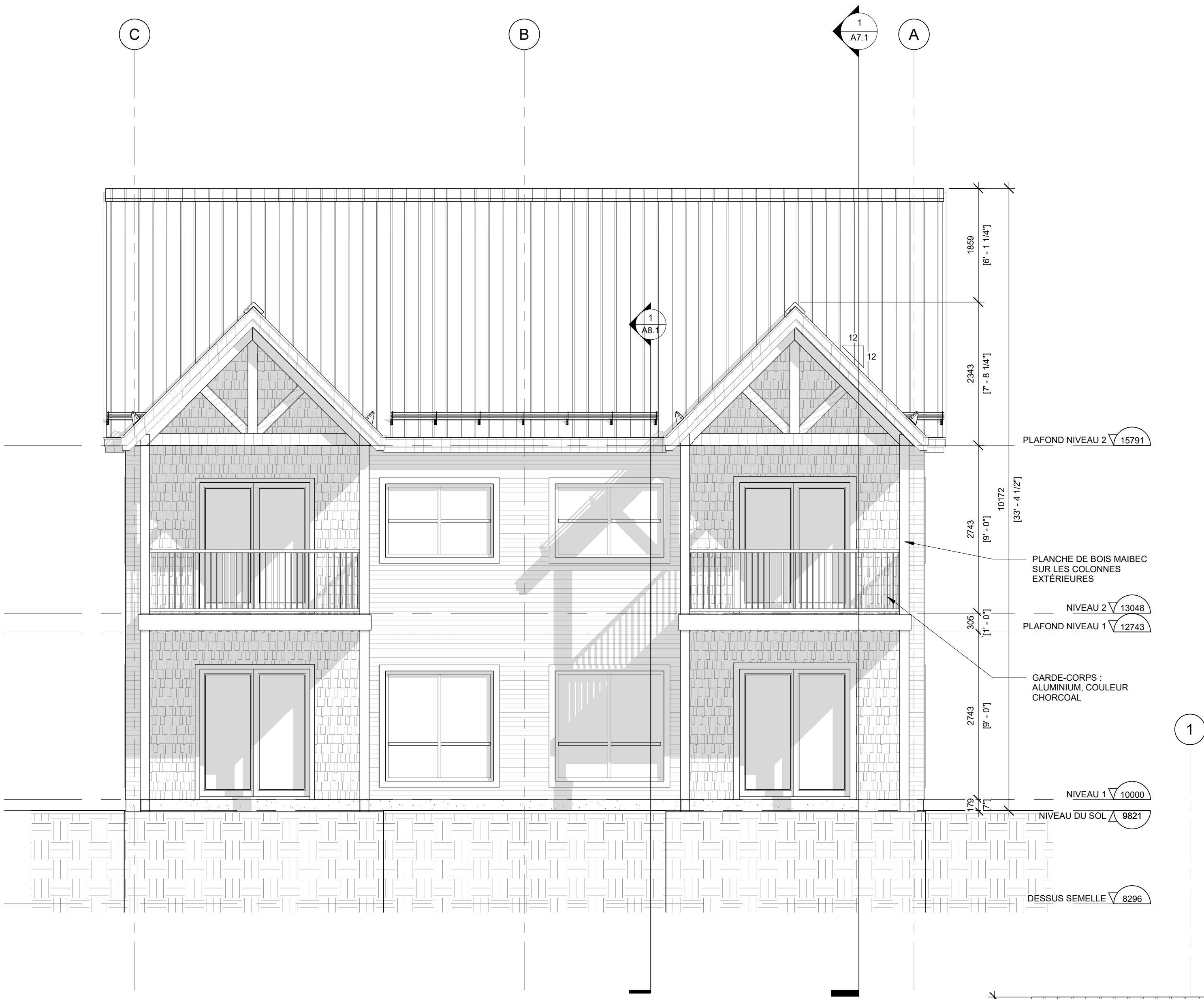
1 ÉLÉVATION ARRIÈRE A6.2 1:50
